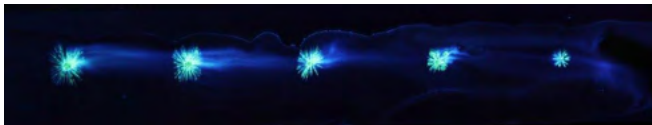
ISO 3452-3 reference test block con penetrante y revelador de la serie ZL-400.
