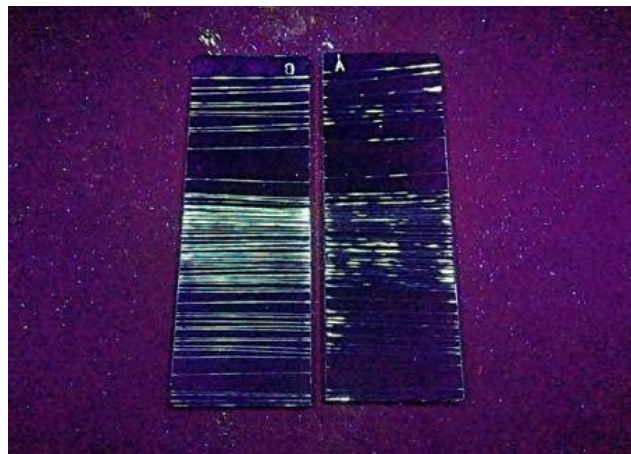
Izquierda: Magnaflux; Derecha: Competidor de nivel 1 equivalente
