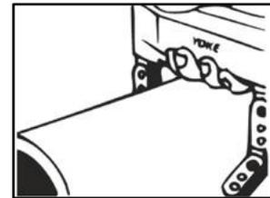
**3. Étrier d'énergie** - Lorsque l'étrier est sous tension, un champ magnétique se forme dans la partie d'essai.
