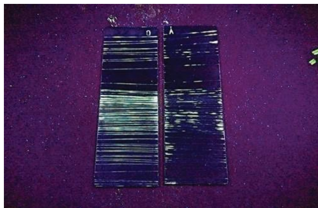
Gauche : Magnaflux; Droite : Concurrent équivalent de niveau 1
