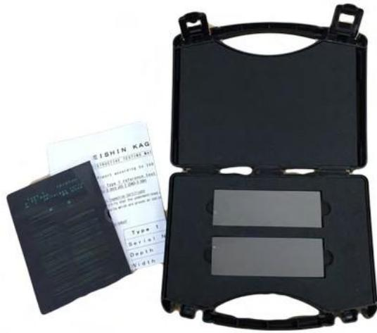
simuler les conditions de production. Habituellement, un panneau est traité à partir de matériaux neufs et inutilisés et l'autre est traité à partir de matériaux de travail ou en cours d'utilisation. Une analyse comparative de l'apparence des panneaux traités évaluera la performance des matériaux utilisés, en notant toute dégradation par rapport aux matériaux non utilisés.
